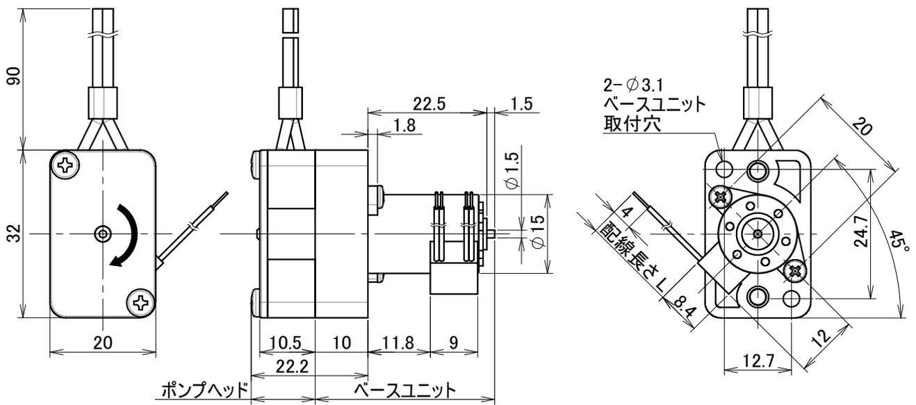
注記： ポンプヘッドのベースユニットへの取付けは、ポンプヘッドを180度回転させてチューブが下側になるようにも、取付けることができます。
